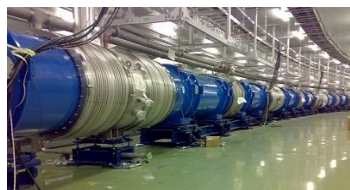
例：加速器で使用される超伝導電磁石
